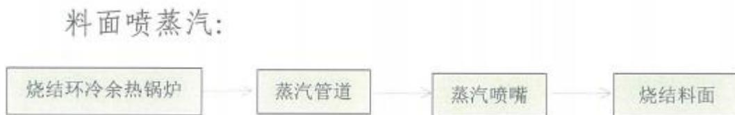
图 6 料面喷蒸汽技术工艺过程图
